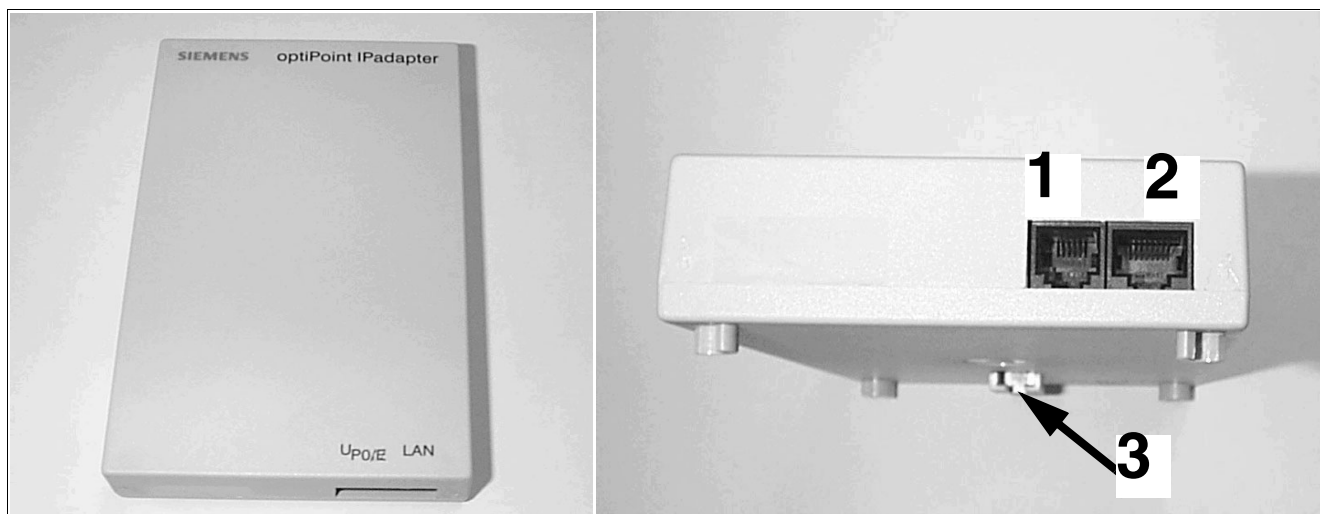
Bild 7-4 Elektrische Anschaltung optiPoint IPAdapter
